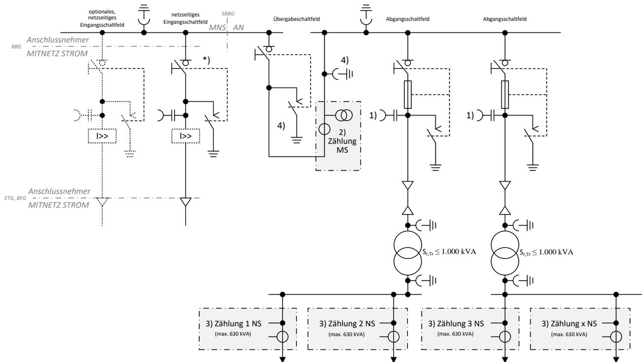
Abb. 22: (ehemals D2a):  $\leq 20\text{-kV}$ -Anbindung mit zwei Abgangsfeldern; Transformatoren  $\leq 1 \text{ MVA}$  mit Übergabe-Lasttrennschalter
