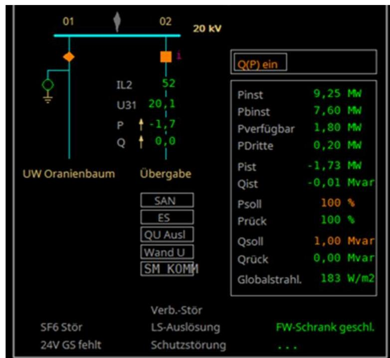
Abb. 19: Beispiel der Darstellung eines MS-Sammelschienen-Anschlusses in einem Umspannwerk im Netzleitsystem der MITNETZ STROM (Die Darstellung eines MS-Netz-Anschlusses erfolgt bis auf  $Q_{soll}/Q_{rück}$  in gleichem Umfang.)
