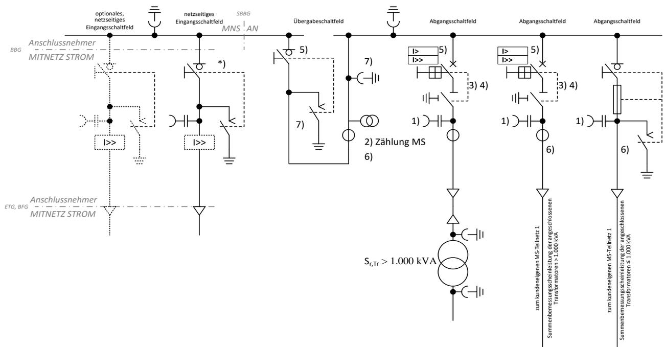
Abb. 23: (ehemals D2b):  $\leq 20$ -kV-Anbindung mit drei Abgangsfeldern (ein Transformator  $> 1$  MVA, zwei Kabelabgangsfelder [kundeneigenes MS-Netz und ein Transformator  $\leq 1$  MVA bzw. ein Transformator  $> 1$  MVA] mit Übergabe-Lasttrennschalter
