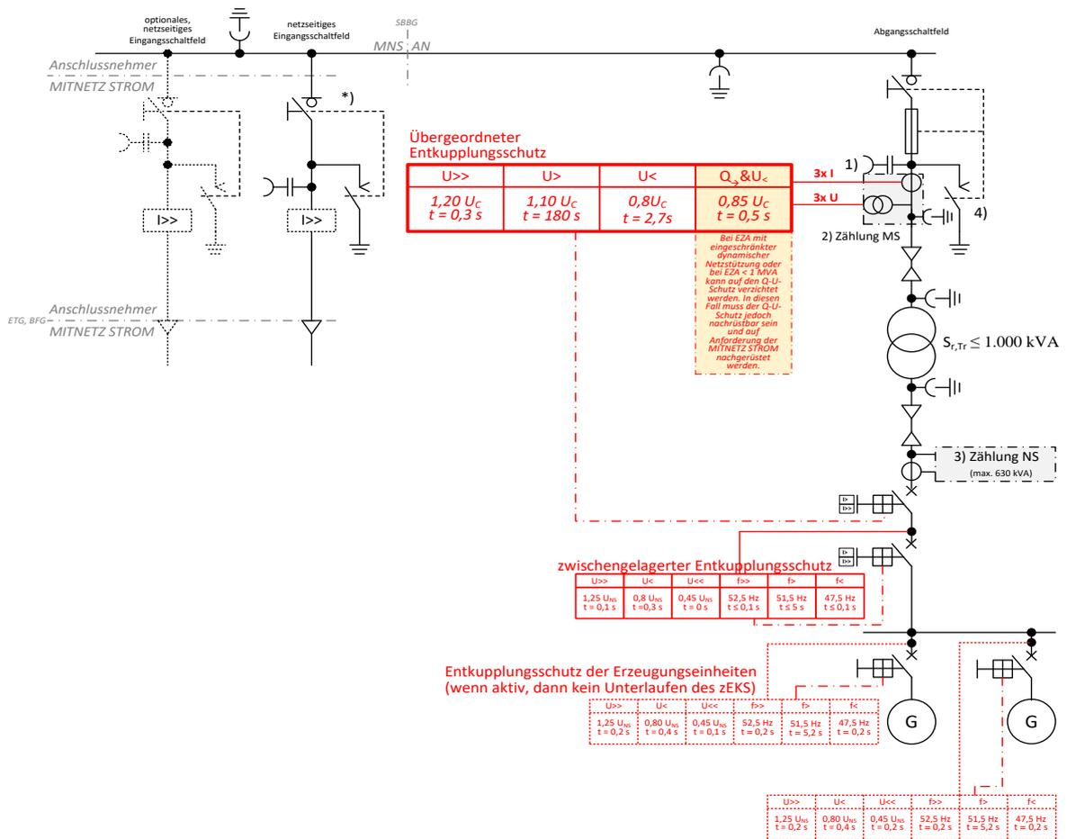
Abb. 27: (ehemals D4c): ≤ 20-kV-Anbindung einer Erzeugungsanlage ≤ 1 MVA
