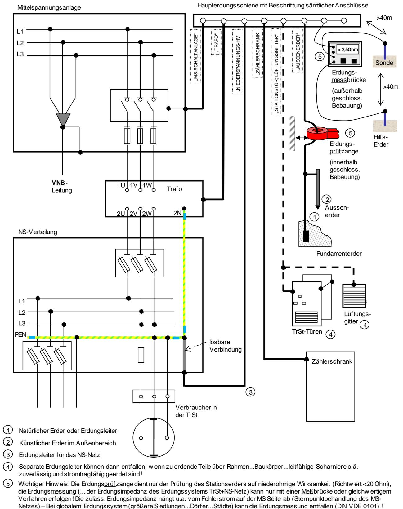
Abb. 7: Gemeinsame Mittel- und Niederspannungs-Erdungsanlage in einer Übergabestation
