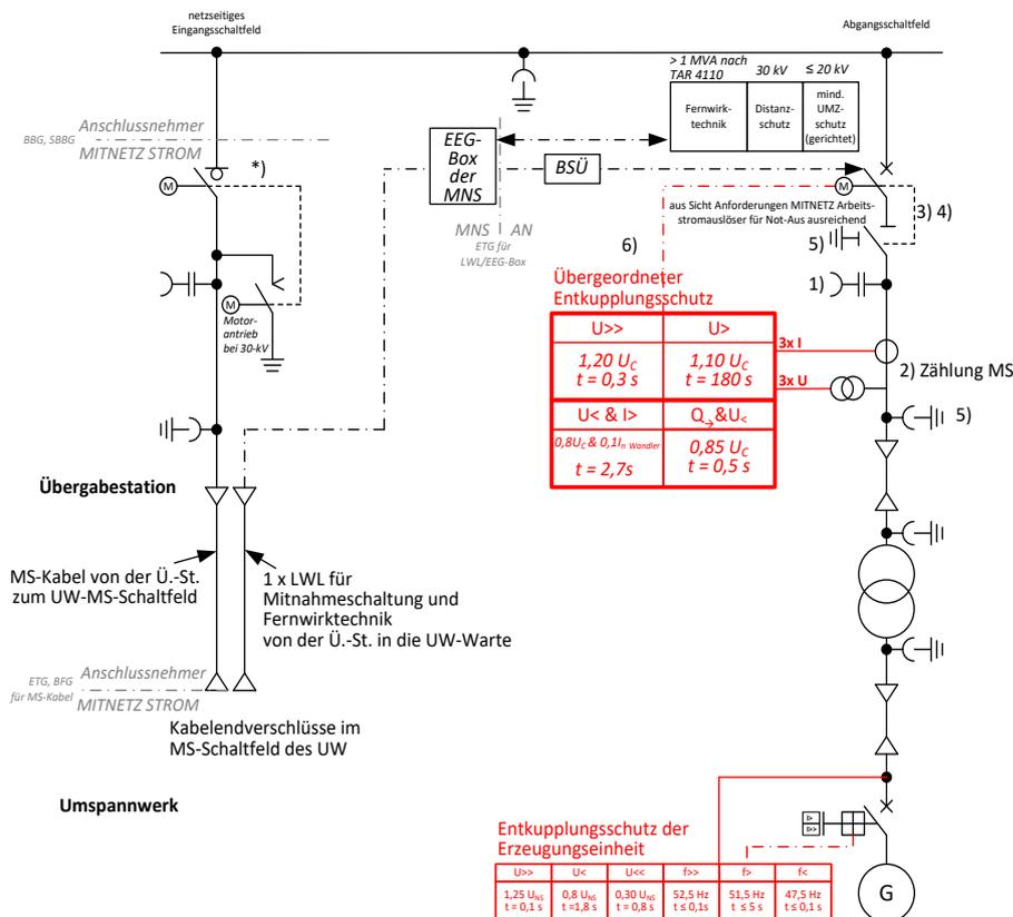
Abb. 24: (ehemals D3a):  $\leq 20$ -kV und 30-kV UW-MS-Sammelschienenanschluss einer Erzeugungsanlage
