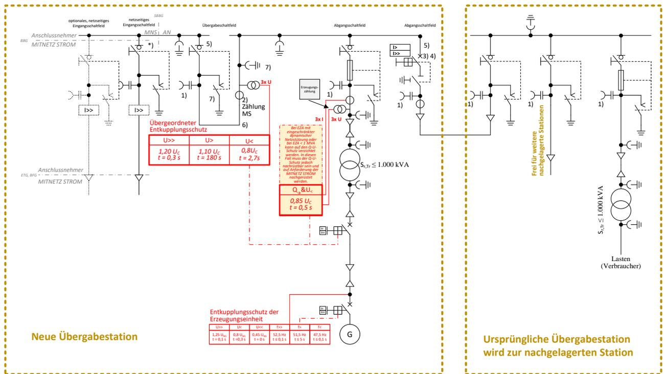
Abb. 33: (ehemals D5d):  $\leq 20\text{-kV}$ -Anbindung einer Erzeugungsanlage mit nachgelagerter Station
