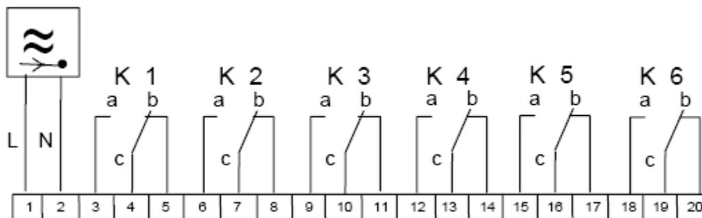
Abb. 15: Relaisplan Funkrundsteuerempfänger
