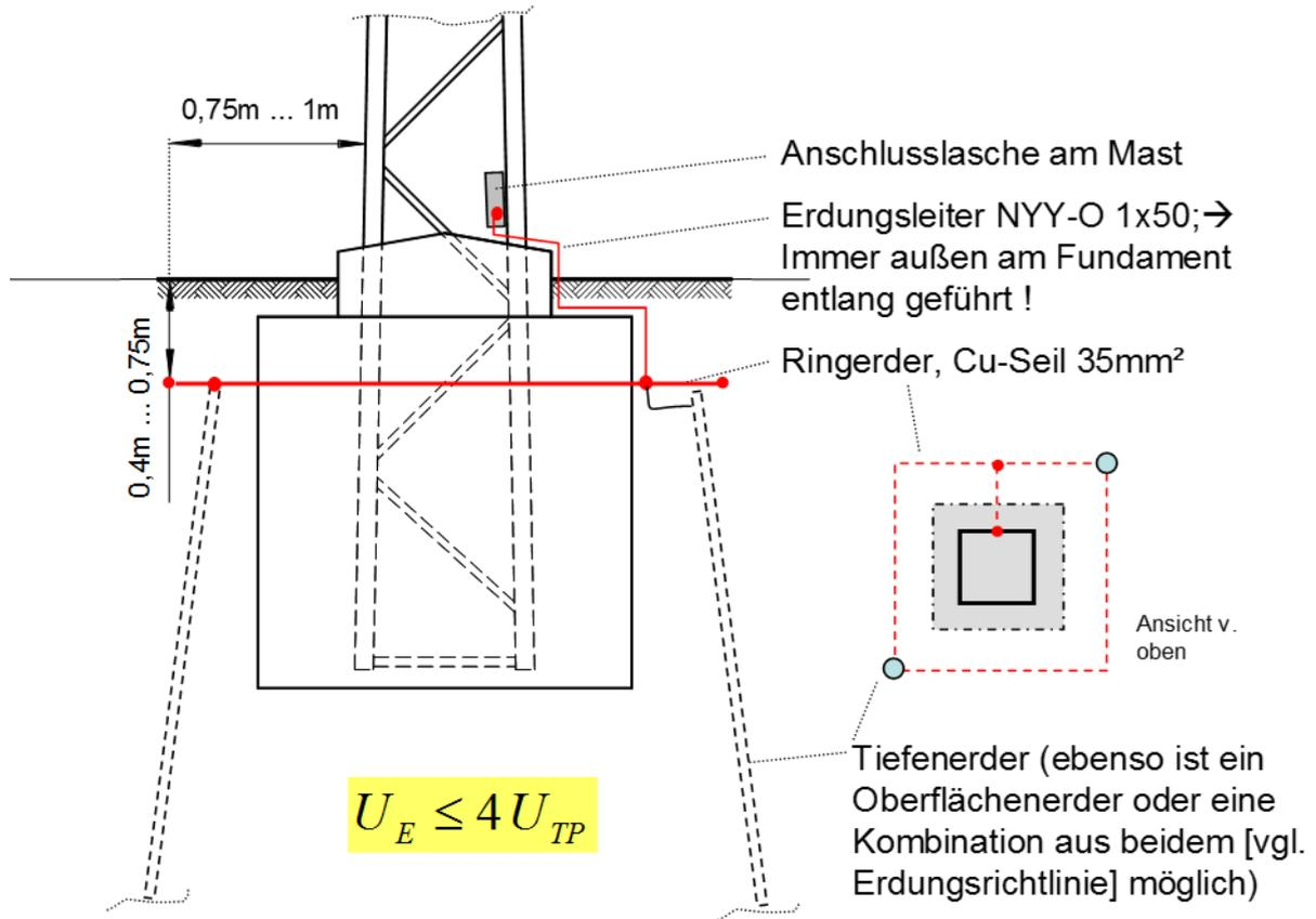
Abb. 6: Standard-MS-Mast-Erdungsanlage
