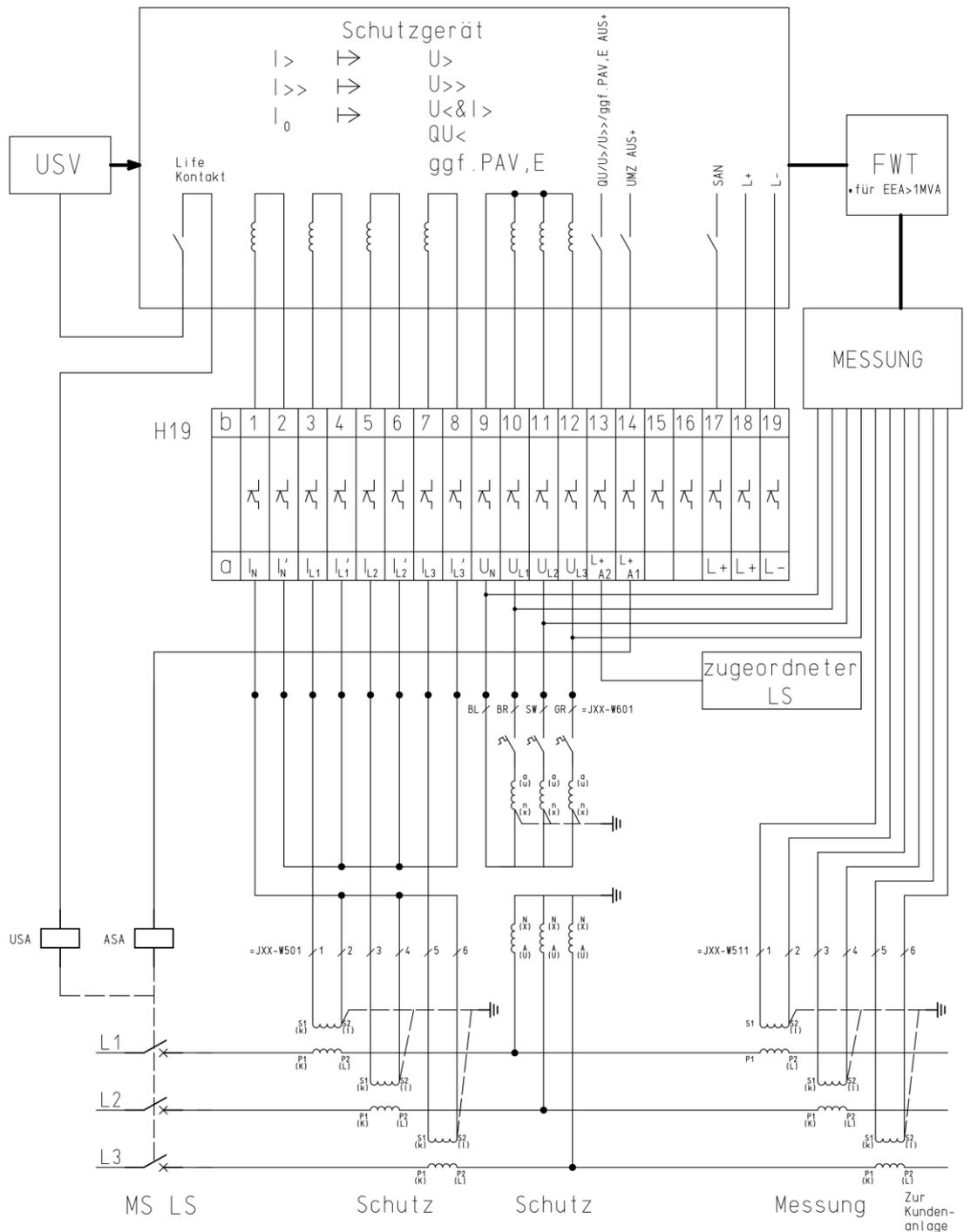
Abb. 43: Wandlerverdrahtung Anbindung UMZ / übergeordneter Entkopplungsschutz
