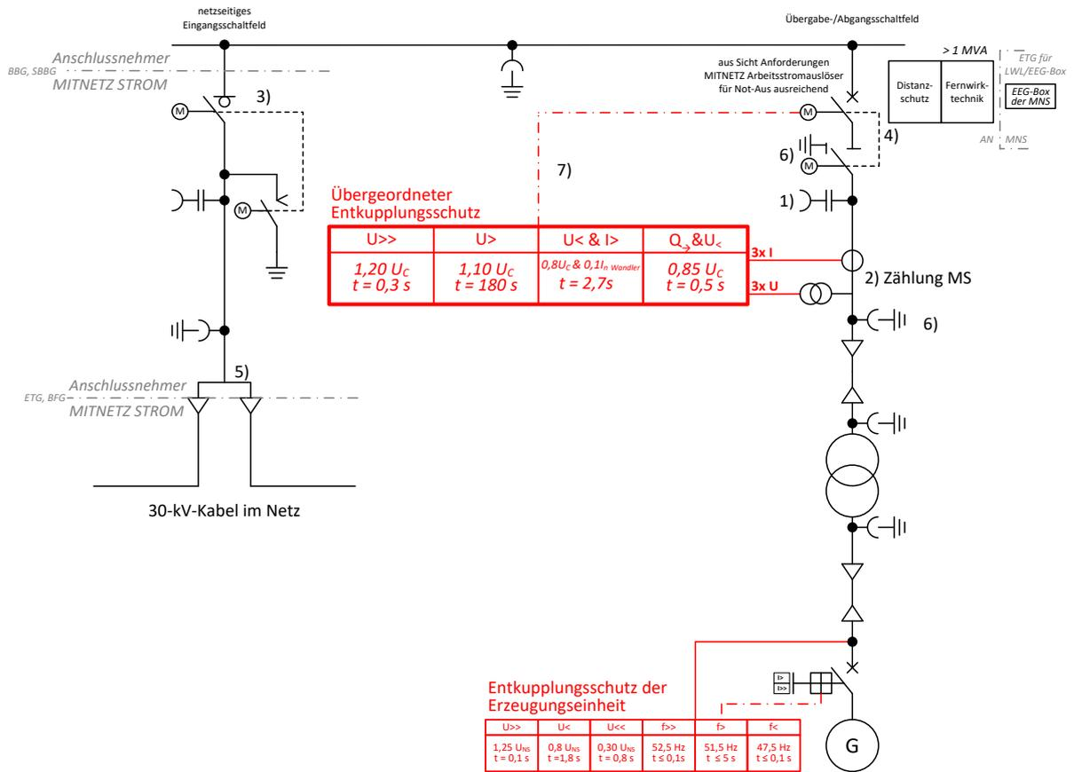
Abb. 35: (ehemals D6): 30-kV-Anbindung einer Erzeugungsanlage im Netz
