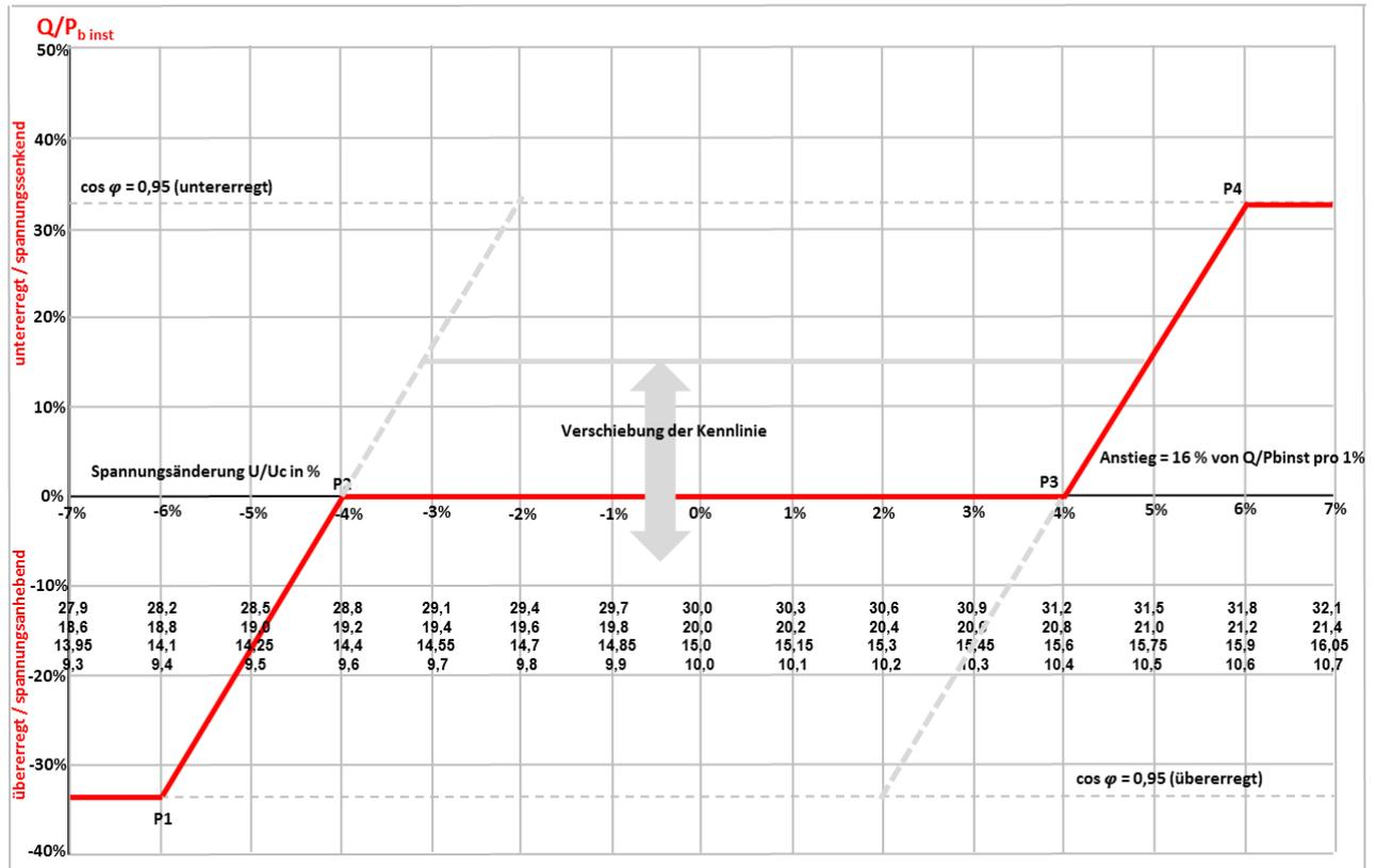
Abb. 14: Standard-Kennlinie Blindleistung mit Spannungsbegrenzungsfunktion, ehemals Bild 10.4
